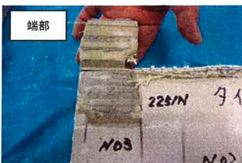
写真 4.10 温冷繰返しによる耐久性試験 試験実施状況及び破壊状況（タイル張り）
