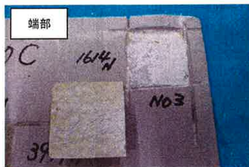
写真 4.9 温冷繰返しによる耐久性試験 試験実施状況及び破壊状況 (マスチック C)
