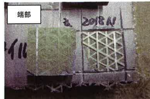
写真 4.5 複合補修層の接着強度試験 試験体及び破壊状況 (タイル張り)
