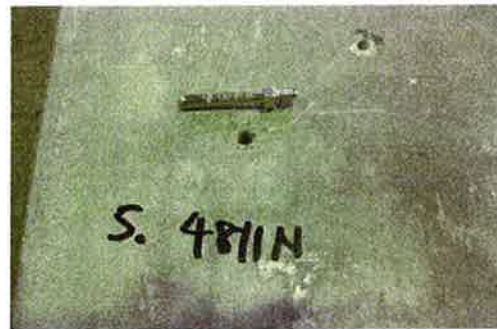
写真 4.2 複合補修層に対するアンカーピンの引抜き試験 試験実施状況及び破壊状況
